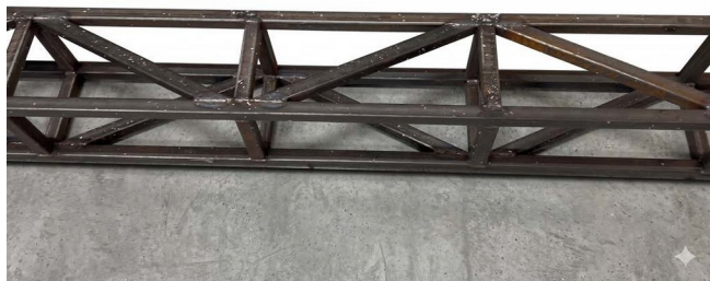
В процессе выполнения: сварной ферменный элемент каркаса после изготовления.
