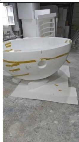
В процессе выполнения: нижняя часть шара после подготовки пенопластовой оболочки.
